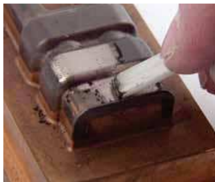
Szikraforgácsoló elektródák megmunkálása
