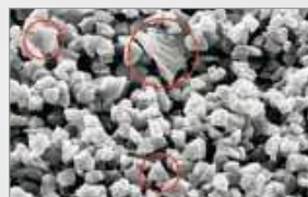
Standard paszta gyémántszemcse 6 µm - rosszul kalibrált, egyenetlen szemcsealakkal -
